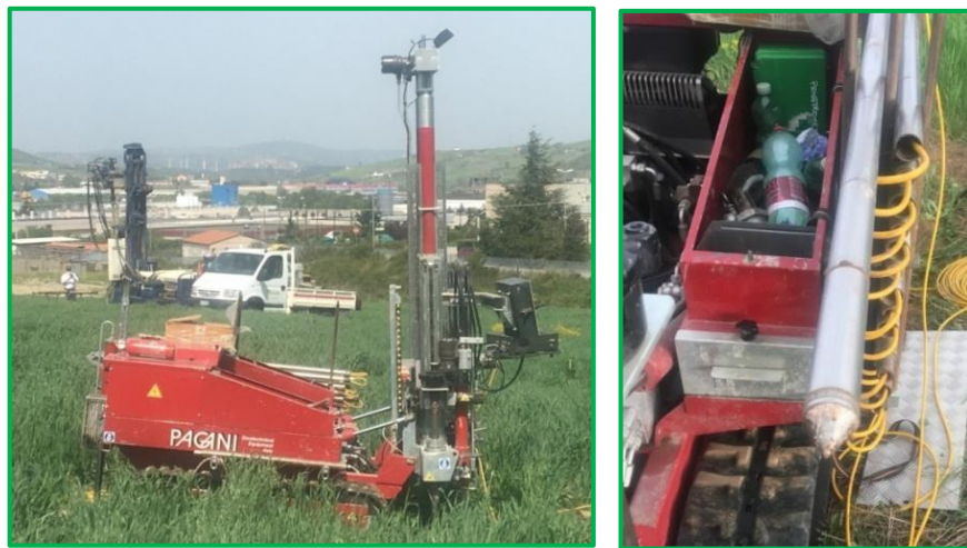
Figura 5: Penetrometro in utilizzato; a destra, particolare del piezocono
