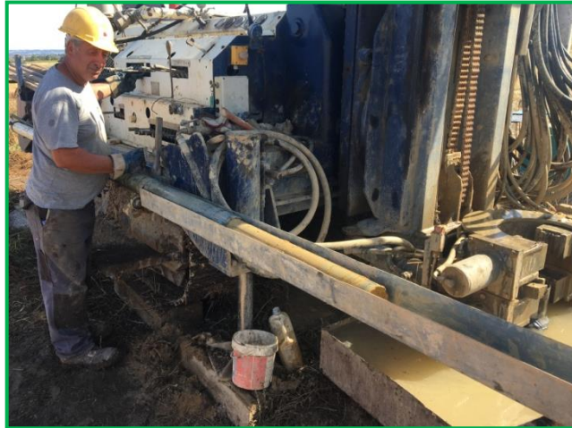
Figura 3: Esempio di estrusione meccanica del carotaggio
