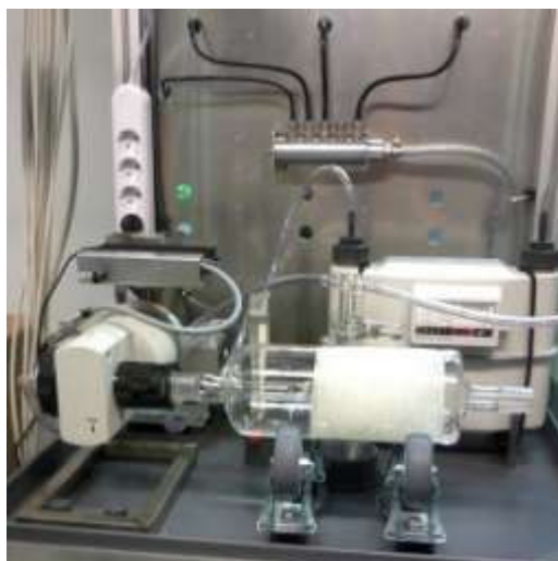
Figura 7. Campionatore ^{14}\text{CO}_2
