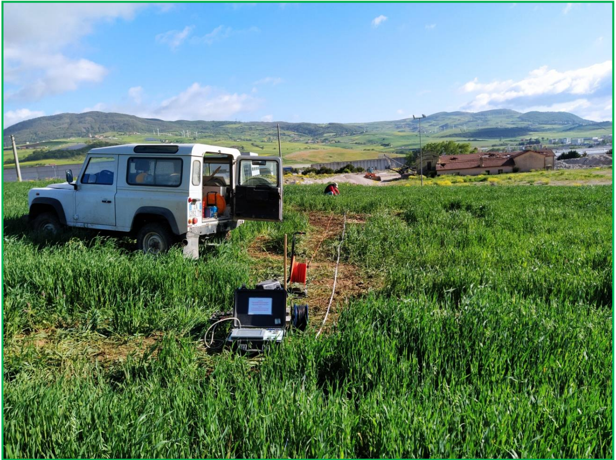
Figura 1: Fasi di acquisizione lungo lo stendimento sismico tipo MASW nell'area di interesse.
