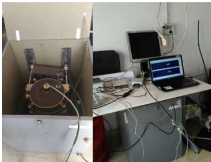
Figura 6. Sistema per la misura del ^{222}\text{Rn}
